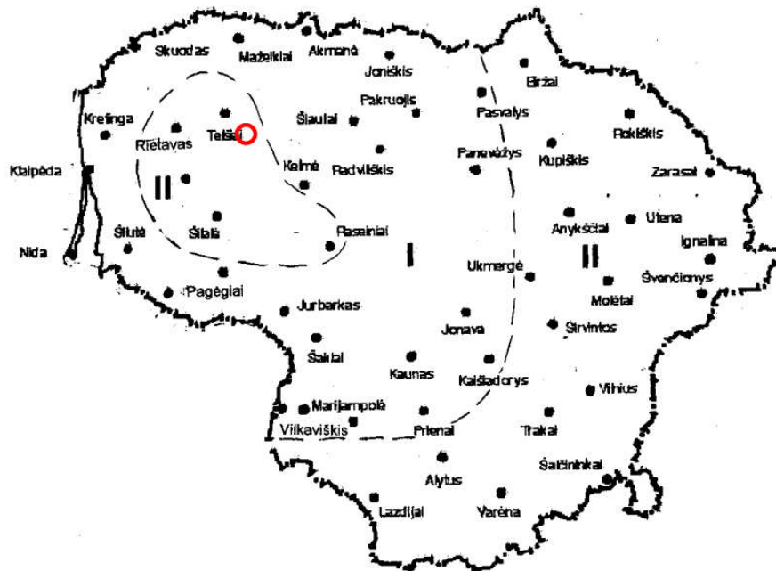
Charakteristinė antžeminės sniego apkrovos reikšmė II-jam sniego rajonui s_k=1,60 \text{ kN/m}^2 . Sniego poveikio dalinis patikimumo koeficientas \gamma_0=1,3 .
